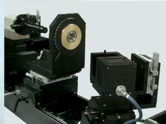
Matrixシリーズは、1台のプラットフォーム上に有限遠測定、無限遠測定／紫外領域～可視光領域～近赤外領域／屈曲光学系の測定を各種モジュールの組み合わせによって選択可能です。購入後に発生する新たな光学系にも柔軟に対応可能なため多くのお客様に支持をいただくベストセラーMTF測定システムです。
